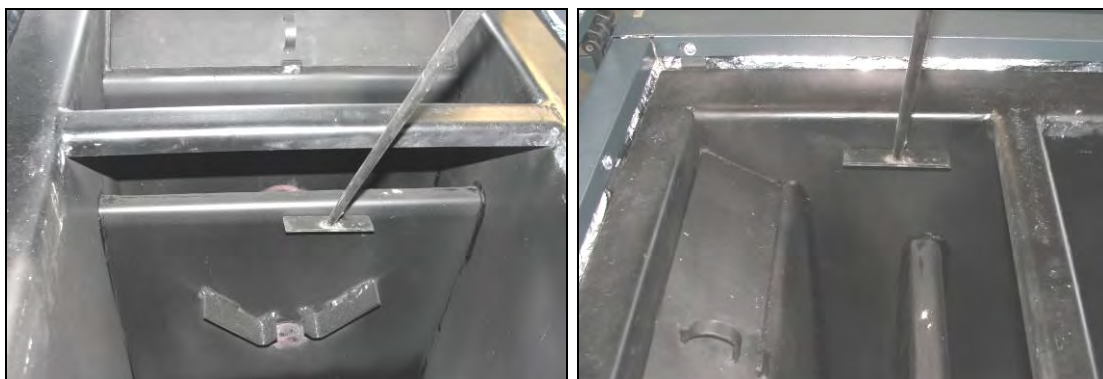
Фигура 6.3. Почистване на пепелния остатък от стените на котела.
